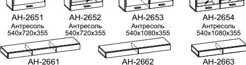
АН-2652 Антресоль 540x720x355 АН-2653 Антресоль 540x1080x355 АН-2654 Антресоль 540x1080x355 АН-2661 Антресоль 138x1620x355
