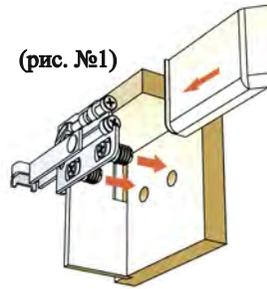
**СХЕМА КРЕПЛЕНИЯ ОТВЕТНЫХ ПЛАНЕК К СТЕНЕ**
